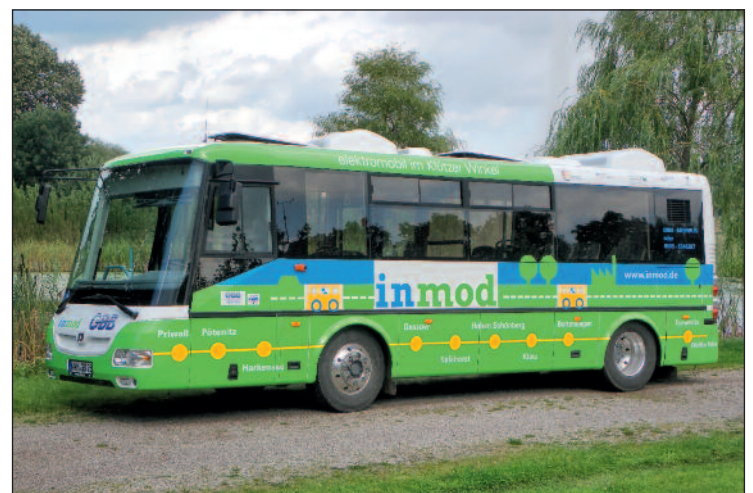
Abb. 4: Im Nordwesten Mecklenburgs – im Klützer Winkel – wird ein SOR -Elektrobus Typ EBN 8 eingesetzt. Dieser Elektrobus der neuesten Generation ist 8 m lang, bietet 22 Sitze und 35 Stehplätze und seine Akkureichweite beträgt 160 bis 170 km.
